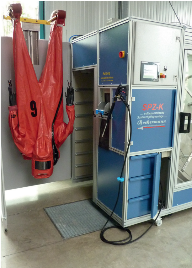
Pistolet de nettoyage à haute pression avec régulateur de pression et système d'enroulement automatique du tuyau
