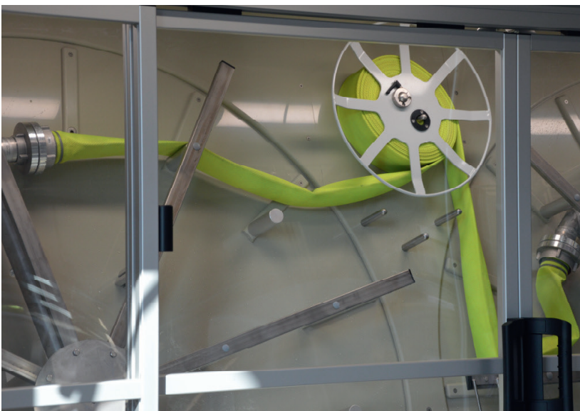
Le disque de guidage du tuyau pour le système d'enroulement permet un enroulement parfait pour tous les types de tuyaux (en option)
