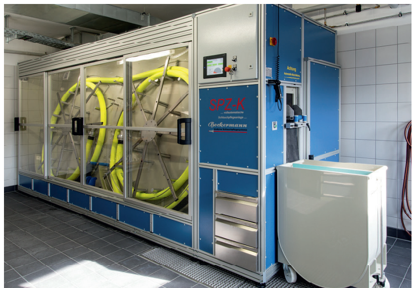
Sécurité maximale lors de l'essai de pression du tuyau entre les disques de l'enrouleur et sécurité en étoile grâce à des portes coulissantes incassables et transparentes pour une vue d'ensemble optimale.
