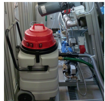
Aspirateur à eau à 3 niveaux avec pompe submersible intégrée pour une vidange automatique
