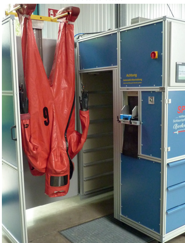
Dispositif de levage de scaphandres à commande pneumatique
