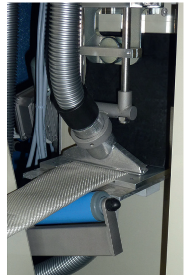
Séchage sous vide (extraction d'eau) pour un séchage optimal du tuyau. En outre, la puissance de nettoyage est accrue.
