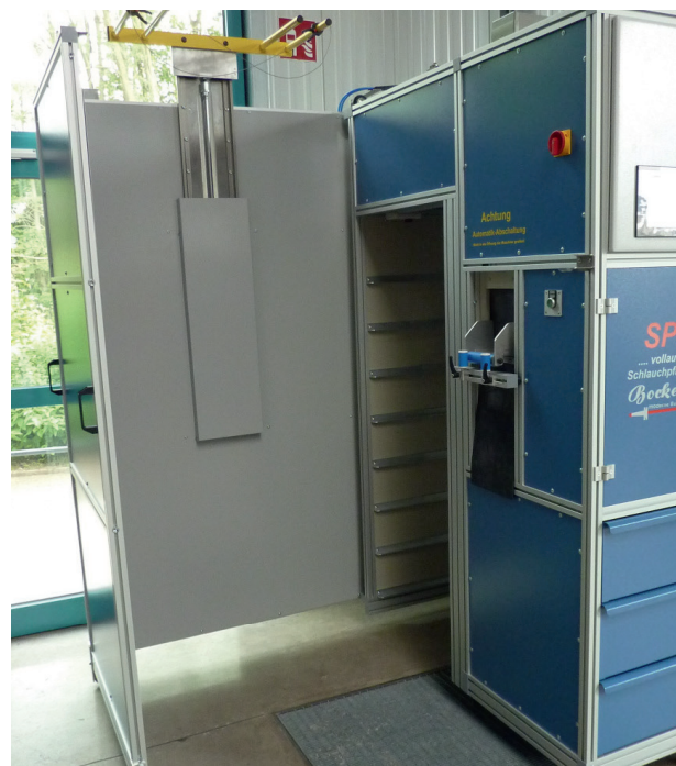
Système d'entretien CSA pour la combinaison de protection lorsqu'elle est retirée, dispositif de levage de la combinaison au-dessus.
