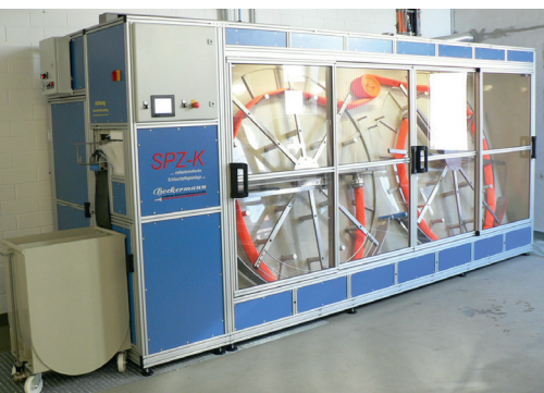
Exemple : Enroulement entièrement automatique avec essorage du tuyau en liaison avec l'essai de pression. Protection optimale des personnes grâce à des portes de sécurité transparentes.
