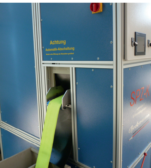
Laveuse de tuyaux haute pression à brosse avec alimentation automatique des tuyaux
