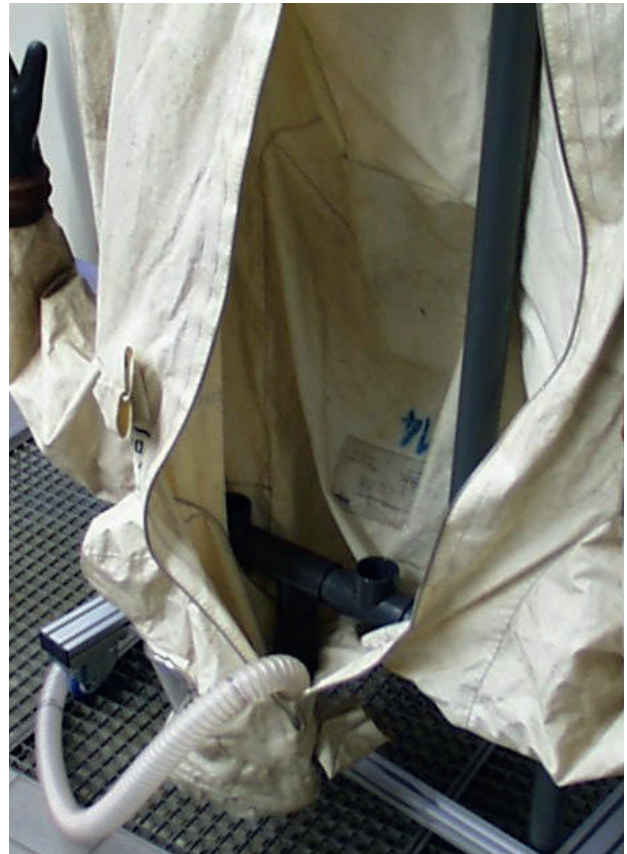
Brillant sec en PVC dur à insérer dans la combinaison de protection
