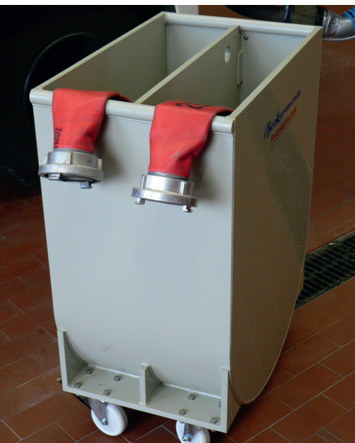
Réservoir de trempage avec cloison et robinet de vidange actionnable par le haut
