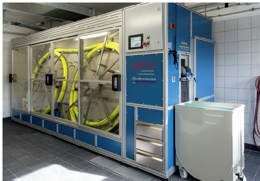
Hoogste veiligheid bij de druktest van de slang tussen haspelschijven en stervormige barstveiligheid in verbinding met breukvaste en doorzichtige schuifdeuren voor een optimaal overzicht.
