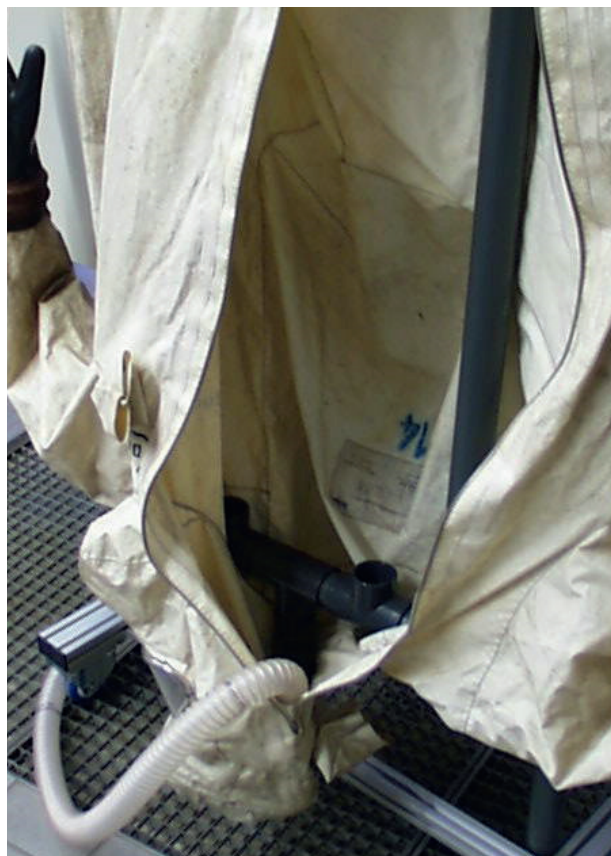
Droogglans uit hard PVC om in het bescherm pak te steken
