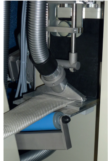
Vacuüm droging (waterafzuiging) voor een optimale droging van de slang. Bijkomend wordt het reinigingsvermogen verhoogt.
