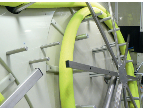
Voorbeeld: optimale barstbeveiliging tussen haspelschijf met stervormige barstbeveiligingsinrichting
