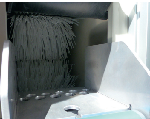
Borstel hogedruk slangenwasmachine met automatische slangeninvoer
