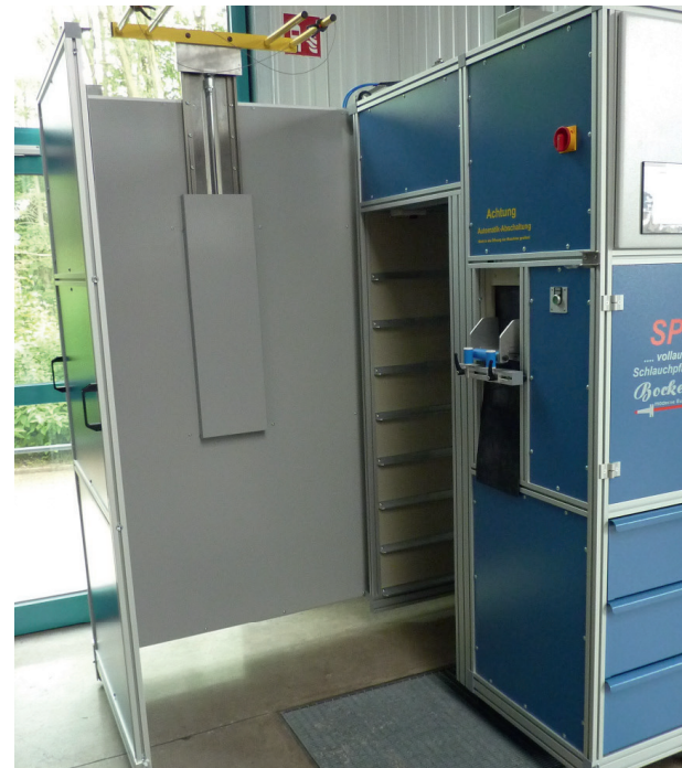
CSA-onderhoudssysteem voor het beschermak in uitgetrokken toestand, hijsinrichting voor het pak boven.
