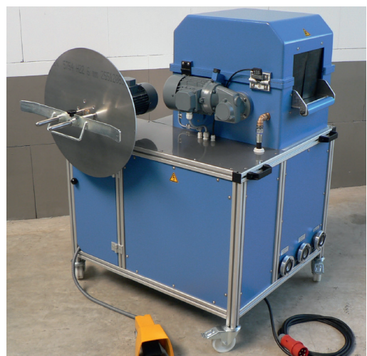
Oprolhaspel zijdeling naast de slangonderhoudseenheid gewenkt voor het enkel of dubbel oprollen van de slang. Bediening via voetschakelaar.
