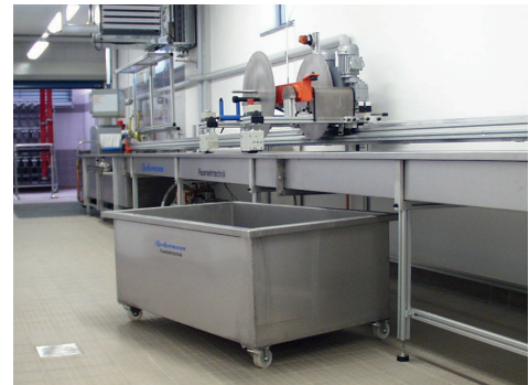
Testwaterterugwinningsreservoir uit inox (inhoud 500l)
