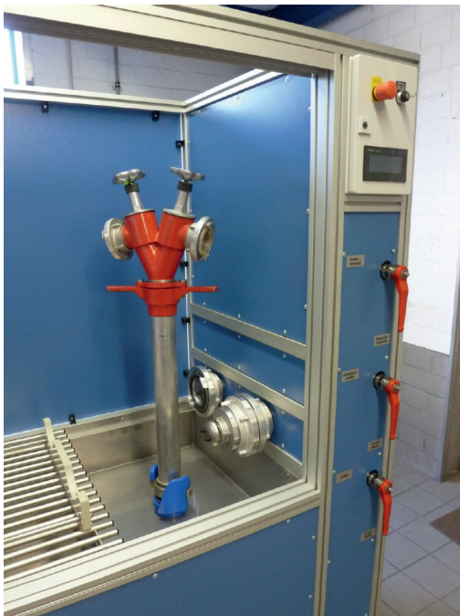
Inspectie van standpijpen
